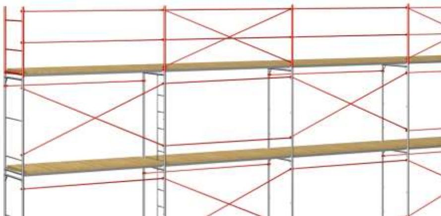
*5.7. Укладку настилов и установку связей ограждений следует производить одновременно.*
