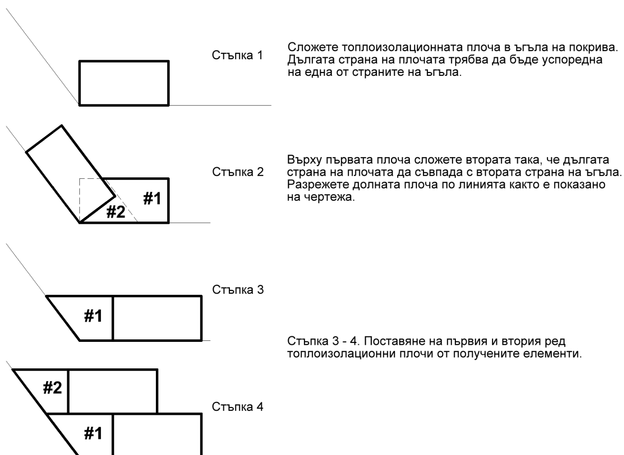
Фиг. 9. Разкрояване и разполагане на топлоизолационните плочи в неправите ъгли на покрива.
