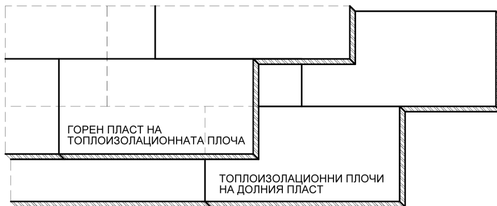
Фиг. 7. Разместване на плочите на горния и на долния пластове при поставянето им.
