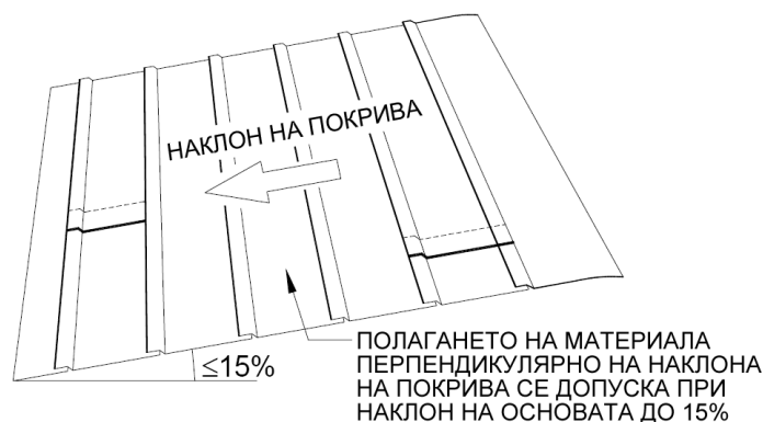
Фиг. 11. Полагане на материала върху ската на покрива.
